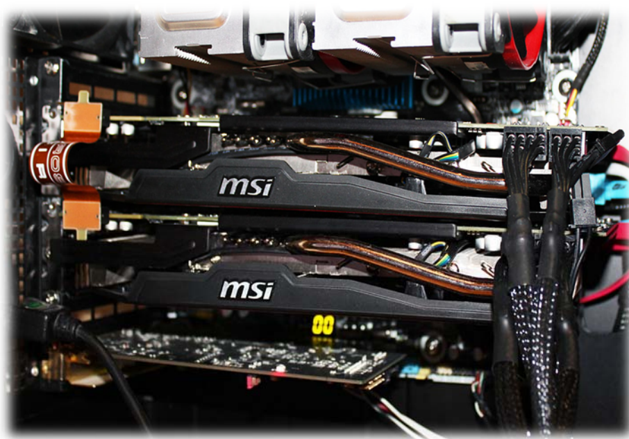
Рис. 5. Збільшення обчислювальної потужності відеокарт за допомогою технології CrossFire
